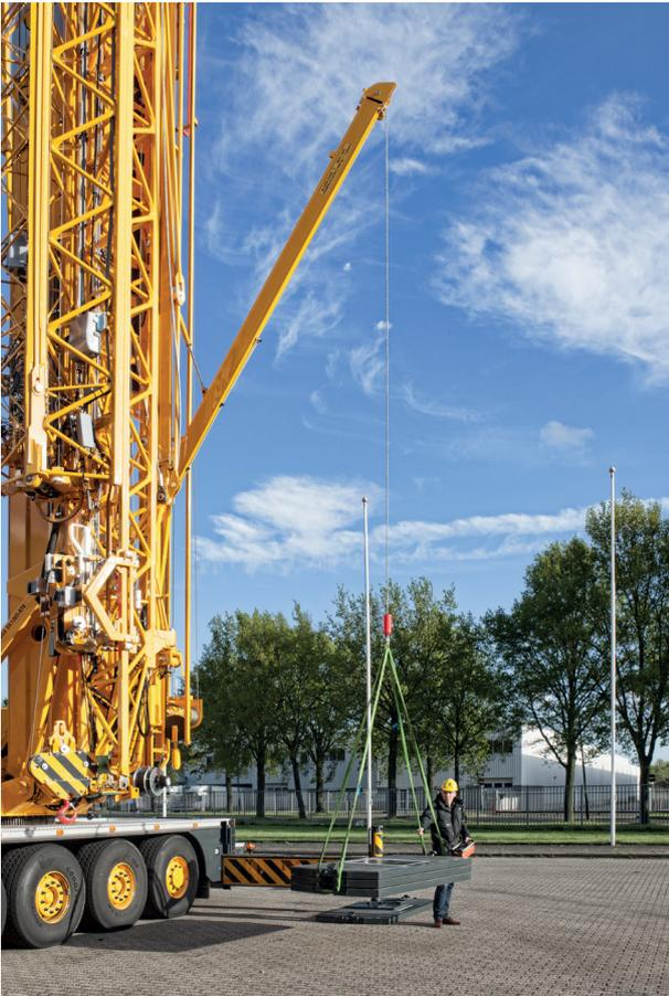
Zusätzlicher Kranarm zum Positionieren der Stahlplatten.
