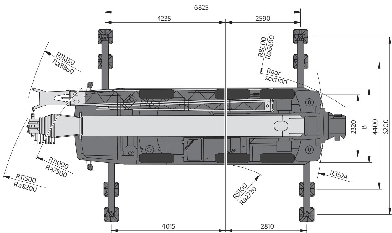
\* With quick release brackets removed. • Ohne Schnellwechselrahmen. • Supports avec dépose rapide. • Sin sistema de desmontaje rápido. • Senza staffe di sgancio rapido. • Быстроразъемное съемное крепление.
